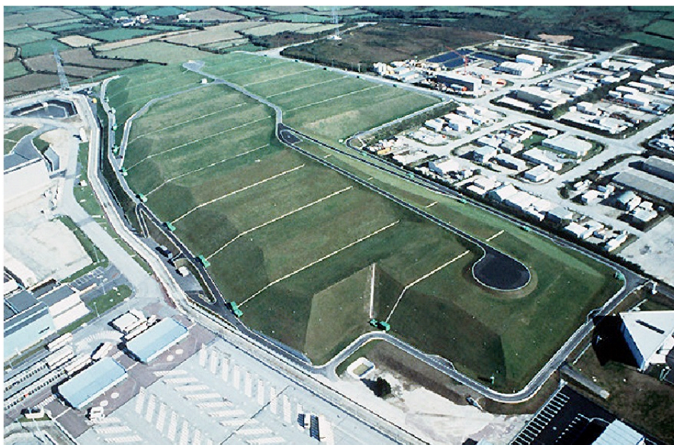
Figura 9 - Deposito Superficiale di La Manche (Francia) Capacità: 530.000 metri cubi (chiuso e sigillato)
