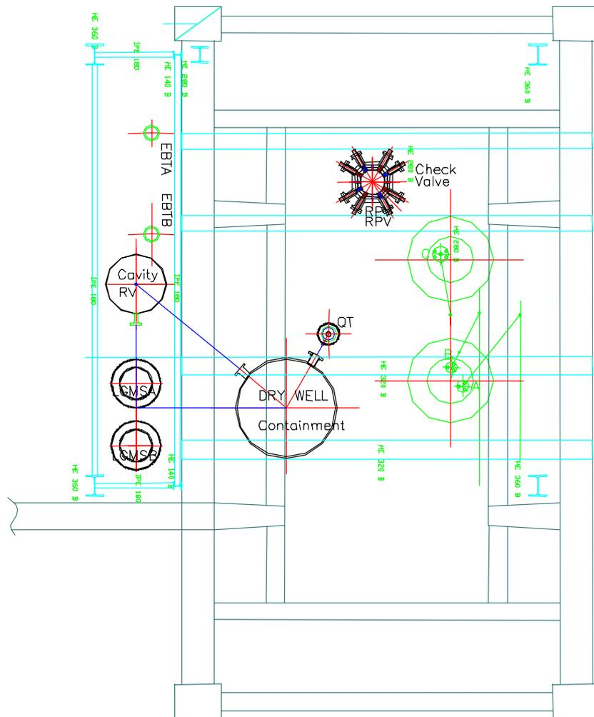
Fig.33 – Facility SPES-3 sulla nuova struttura, pianta del quinto piano
