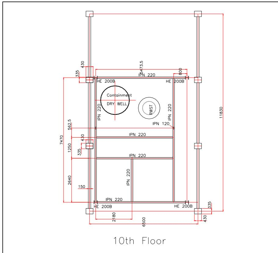
Fig.12 – Facility SPES-3, pianta del decimo piano
