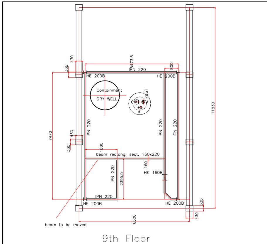
Fig.11 – Facility SPES-3, pianta del nono piano
