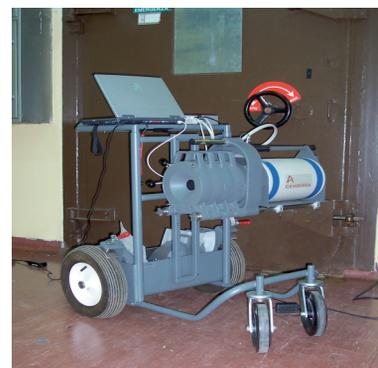
*Strumento portatile per misura gamma*
