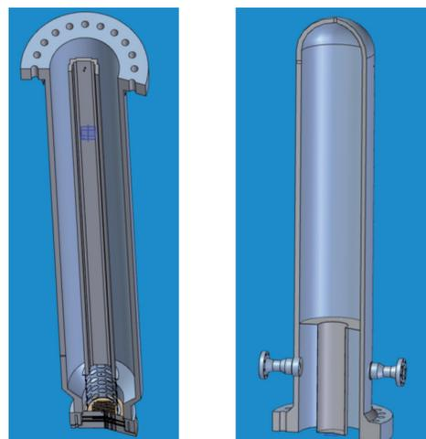
Sezione del fondo e della parte alta del vessel di SPES-3
