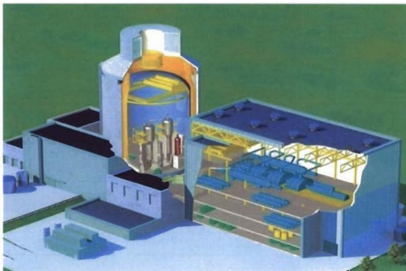
**Fig. 1.24 – Spaccato del reattore AP-1000 di Toshiba-Westinghouse**
