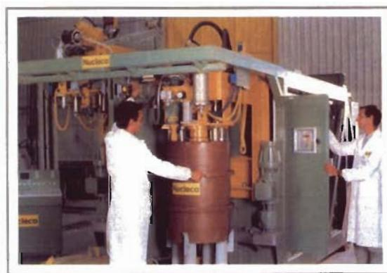
**Fig. 4.18 – Impianto mobile di supercompattazione**
