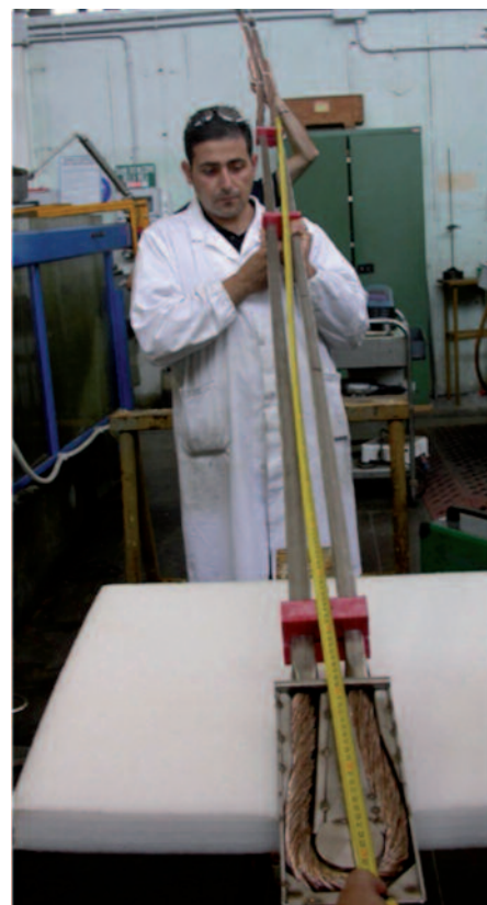
Preparazione di campioni prima della spedizione a SULTAN. In primo piano il cosiddetto "hair-pin joint" sviluppato da ENEA per questi test
