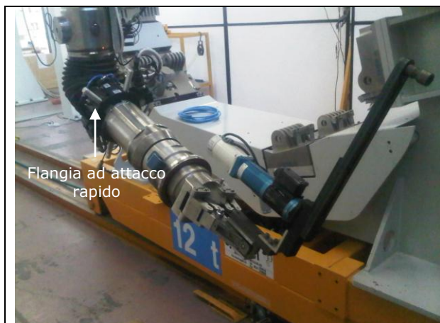
Fig. 5 Braccio esistente con flangia per sostituzione terminale
