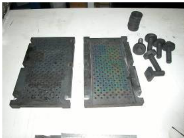
Figura 17 – infiltrazione fibre di carbonio; stampo utilizzato per la preparazione della preforma del fondo e del coperchio
