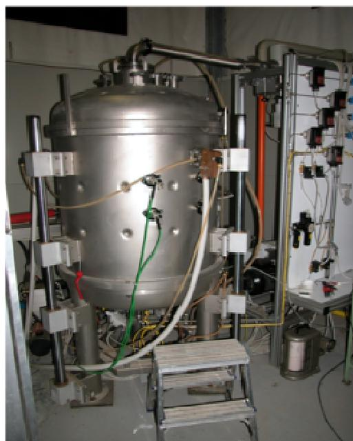
**Figura 4 – Impianto CVI in FN S.p.A.**
