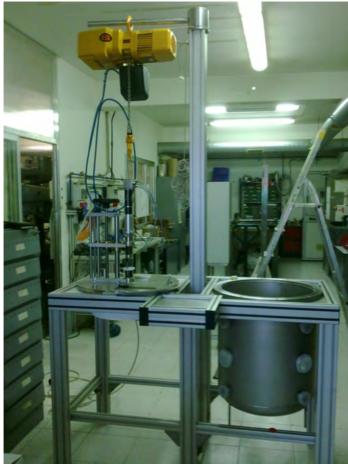
Fig.1 Foto dell'apparato sperimentale per le prove in Pb17Li in fase di realizzazione.
