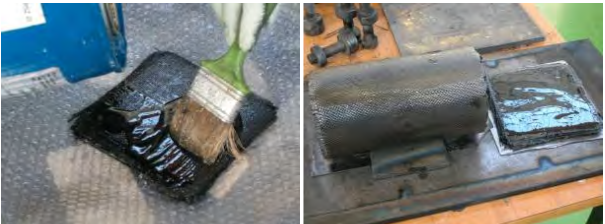
Figura 21 – Impregnazione del crogiolo prima del trattamento termico
