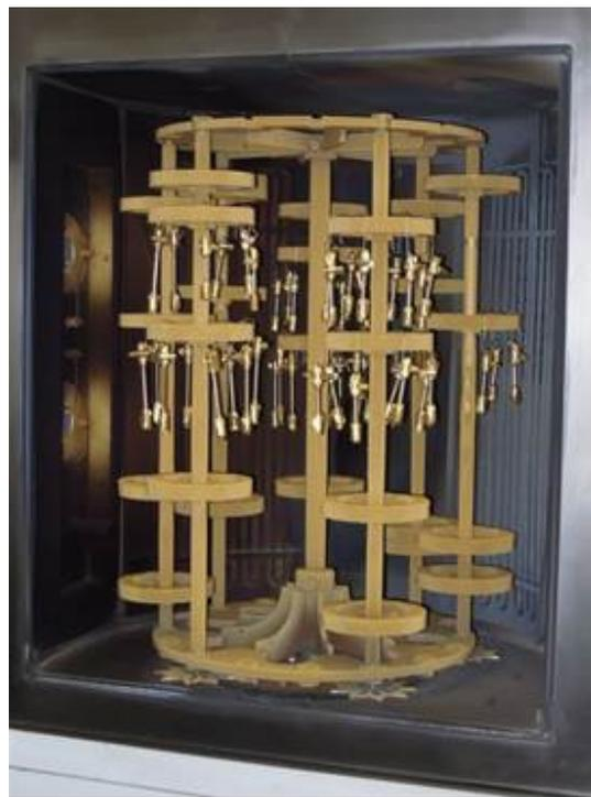
**Figura 4.7** – Vista generale della girota con i campioni all'interno della camera di deposizione (campagna di deposizione TiN precedente Piano Annuale di Realizzazione).
