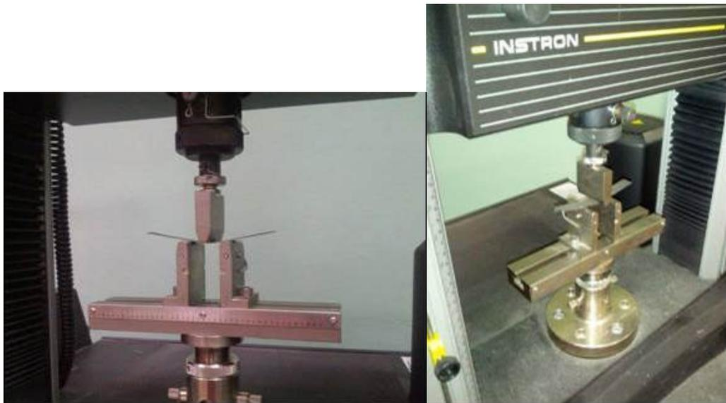
**Figura 7.1** - Set-up sperimentale della prova di *bending* a tre punti.
