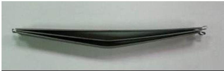
**Figura 8.15** - Provini FeCrAl prima della flessione e dopo la flessione a due frecce diverse.
