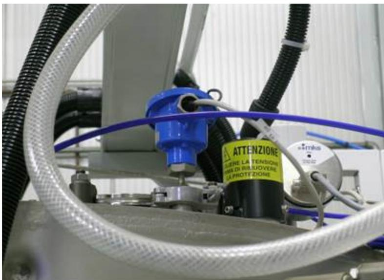
**Figura 4.4 – Alloggiamento termocoppia riscaldatore**
