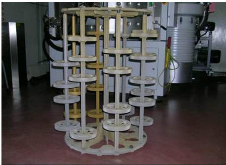
**Figura 4.5** – Portasubstrati mostrato all'esterno della camera di deposizione
