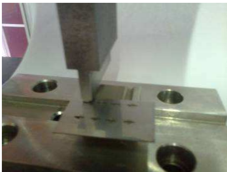
Fig. 23 – Prova di piega su lamina con asole, campione dopo piega vicino ad asole a simulare la griglia
