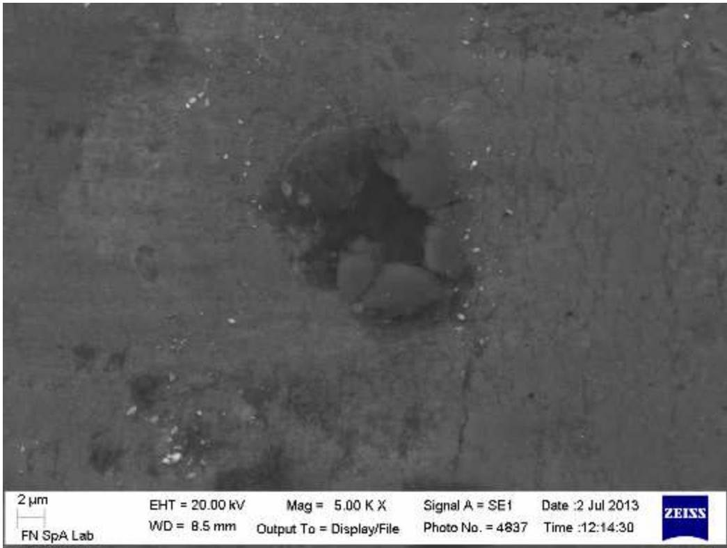
Fig. 33 – Immagine al SEM della lamina incrudita al 75% - superficie a 500 X
