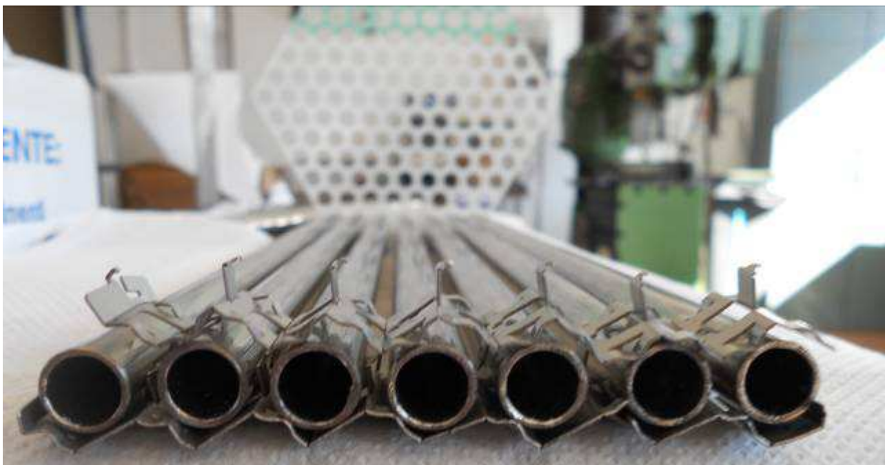
Fig. 59 – Fase di montaggio della seconda componente di griglia
