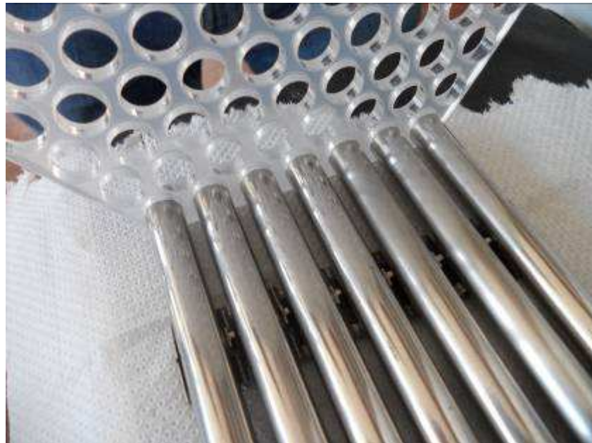
Fig. 56 – Particolare del piatto esagonale in plexiglass realizzato per mantenere in posizione distanziata le barrette all’atto del montaggio e visione degli uncini della prima componente di griglia che passano fra una barretta e l’altra in attesa della componente 2 della griglia cui agganciarsi.
