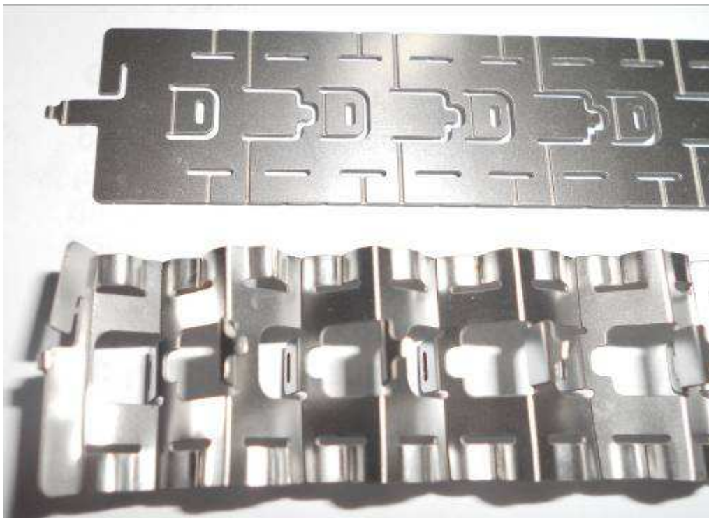
Fig. 56 – Confronto fra componente foto-tranciata e dopo realizzazione nicchie e piegature
