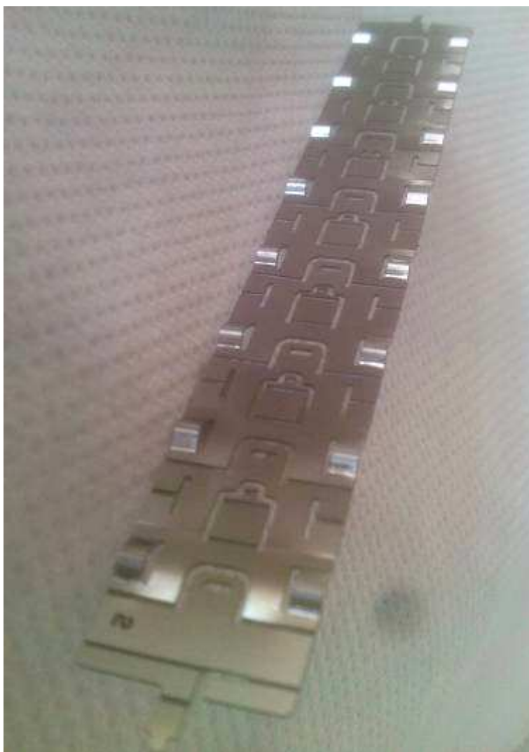
Fig. 54 – Esempio di componente di griglia a seguito della realizzazione nicchie (vista dall'alto)
