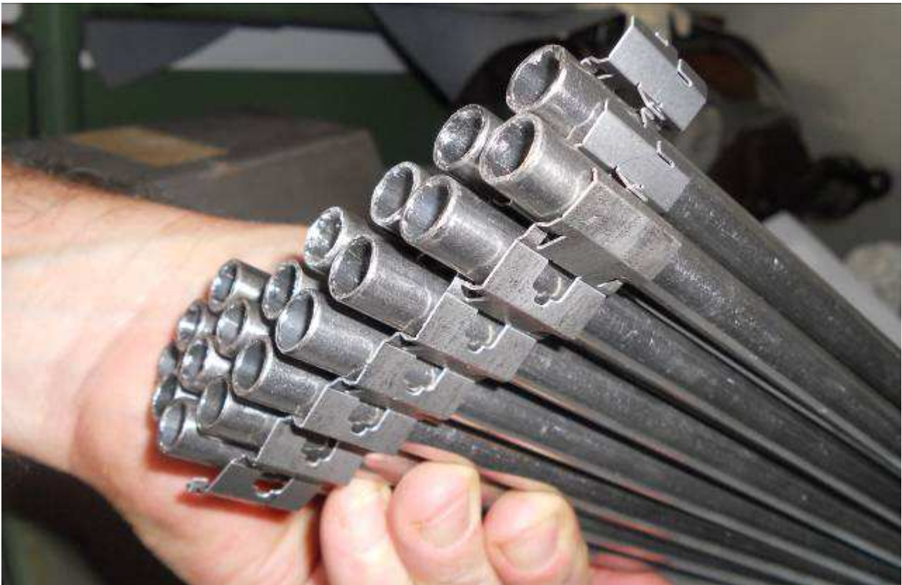
Fig. 62 – Vista del fascio parziale che è bloccato dalle componenti di griglia agganciate fra loro
