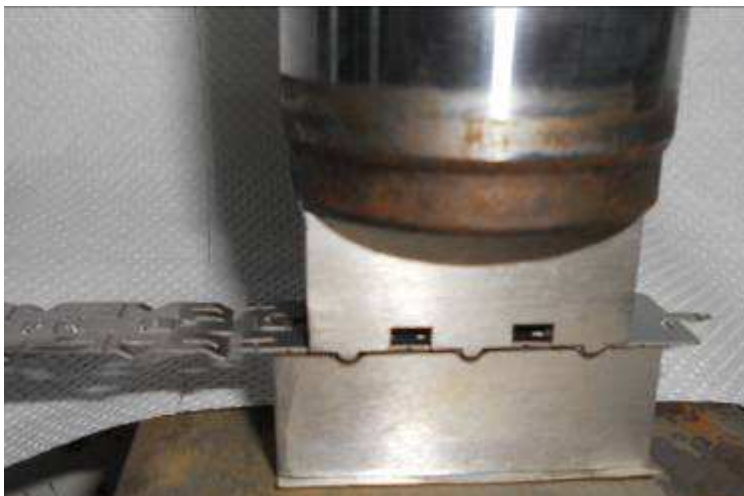
Fig. 53 – Effettuazione delle coppie di nicchie con lo stampo triplo punzone
