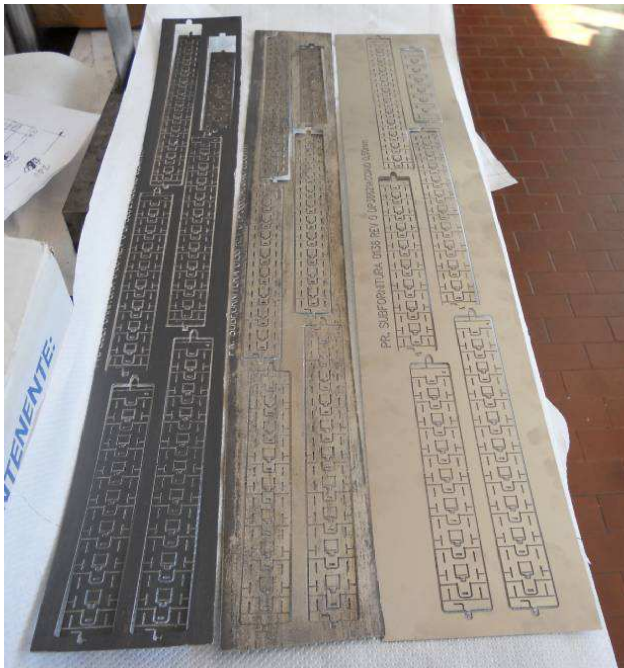
Fig. 44– Immagine delle lamine dopo foto-tranciatura chimica: a sx lamina incrudita al 50%, al centro lamina dopo trattamento di solubilizzazione e distensione, a dx lamina in AISI 301 di prova
