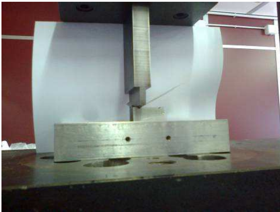
Fig. 19 – Punzone e matrice realizzati in FN, montati sulla Instron: prima prova di piega per testare l'attrezzatura (fase di piegatura)
