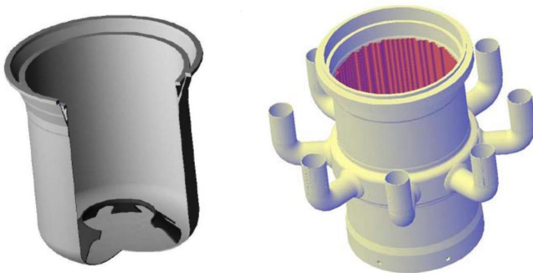
Figura 4 Vessel ed "inner vessel" dell'impianto ALFRED
