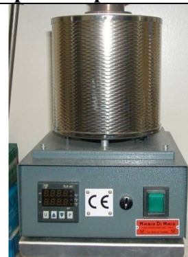
Fornetto verticale operante fino a 1100°C
