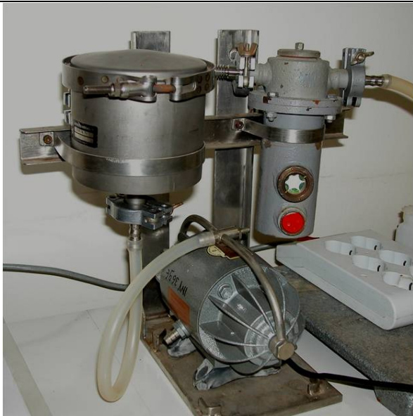
Pompa per insufflaggio d'aria con relativi filtri
