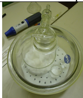
Conservazione del precipitato in essiccatore sotto vuoto
