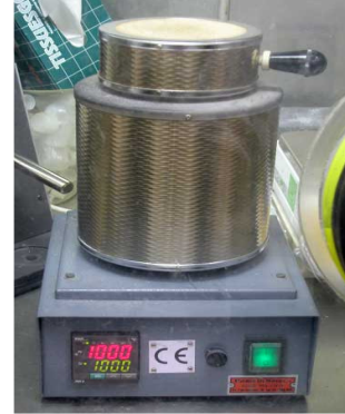
Fornetto alla temperatura di 1000°C
