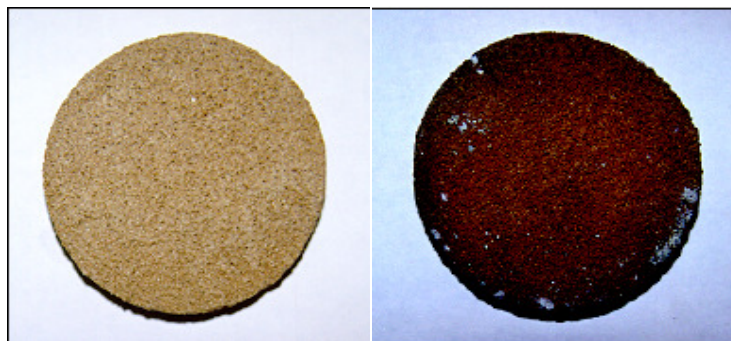
Figura 5. Fotografie dei filtri contenenti ceneri volanti prima (a sinistra) e dopo (a destra) l'intrappolamento di cesio gassoso [5]
