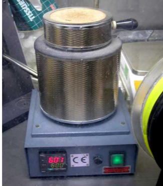
Fornetto alla temperatura di 600°C
