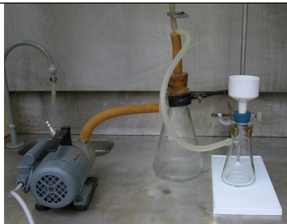
Filtrazione del precipitato sotto aspirazione
