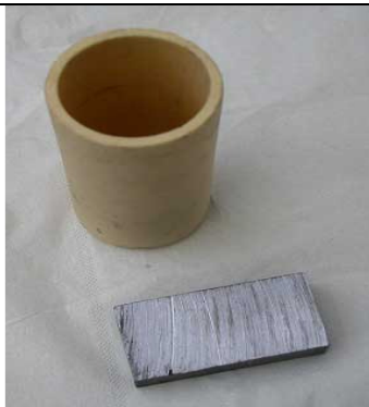
Panetto di Pb e crogiolino in allumina
