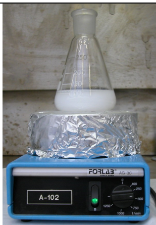
Formazione di un precipitato lattiginoso sotto costante agitazione
