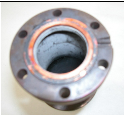
CsCl condensato all'interno del reattore
