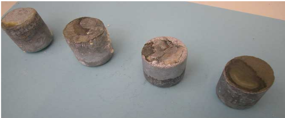
Figura 3 – Campioni di piombo cristallizzato al termine delle esperienze
