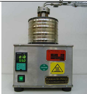
Fornetto verticale operante fino a 1200°C
