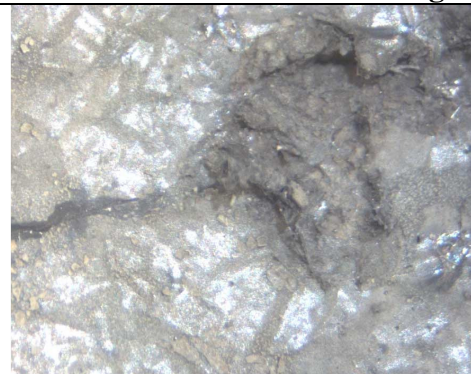
Superficie di Pb cristallizzato
