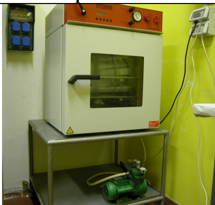
Essiccazione del precipitato a 120°C in stufa da vuoto per 2 ore
