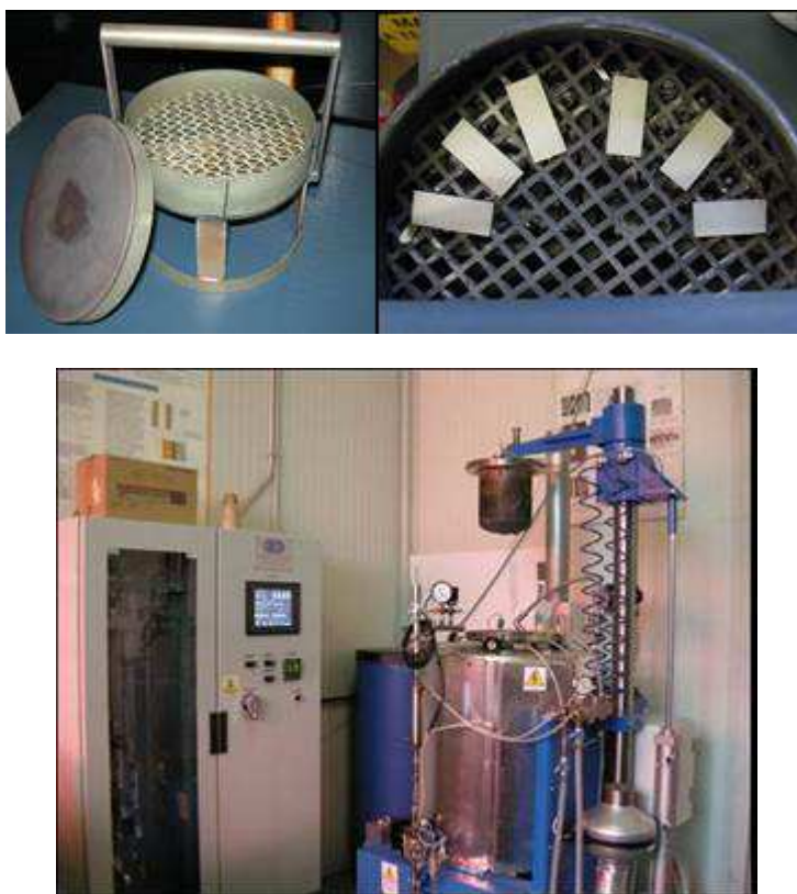
Figura 2 – Impianto diffusion coating presso CSM (sotto) e dettaglio retort (sopra)
