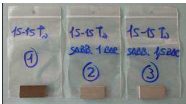
Figura 1 – Aspetto della superficie dei provini (esempio substrato: 15 – 15 Ti) prima e dopo trattamenti di sabbiatura a diversa pressione.
