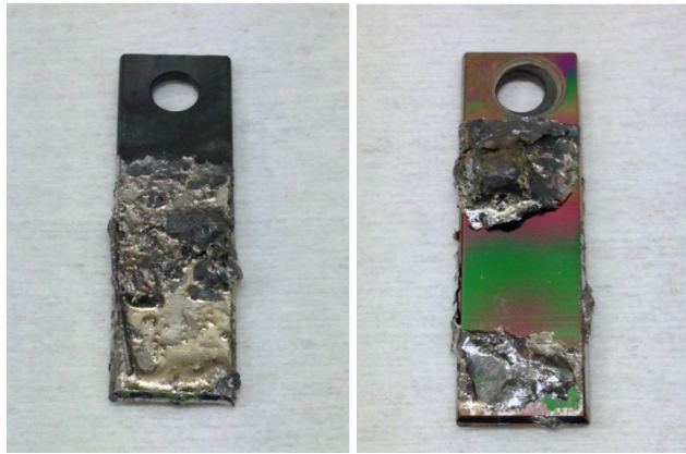
Figura 7. Piattine di 1515Ti sottoposte a prove di corrosione in Pb stagnante, nelle condizioni di Fig. 6. A sinistra: piattina non ricoperta; a destra: piattina ricoperta, dalla quale è stato staccato volontariamente un pezzetto di Pb solidificato.
