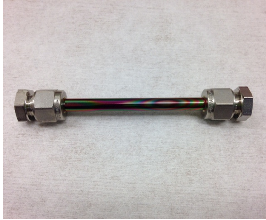
Figura 5. Campione di tubo cilindrico di AISI 316L con coating di allumina, chiuso con tappi di tipo Swagelok, per effettuare valutazioni di comportamento a creep sotto la pressione interna di vapor d'acqua.
