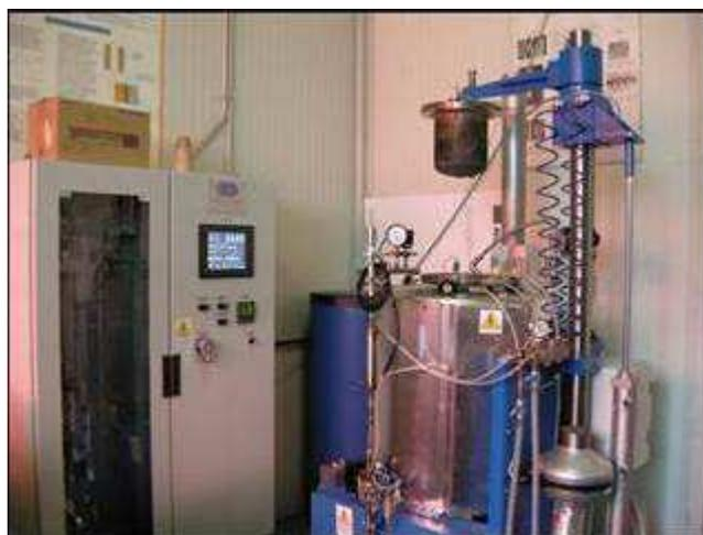
Figura 1- Impianto diffusion coating presso CSM (sotto) e dettaglio retort (sopra)
