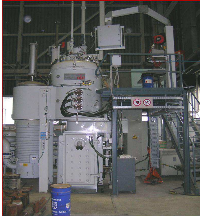
Fig. 2 – Impianto VIM (ALD-Vacuum Technologies) presso il CSM
