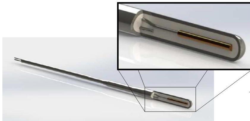
Figura 22 - Disegno concettuale del rivelatore SPND Thermocoax standard.
