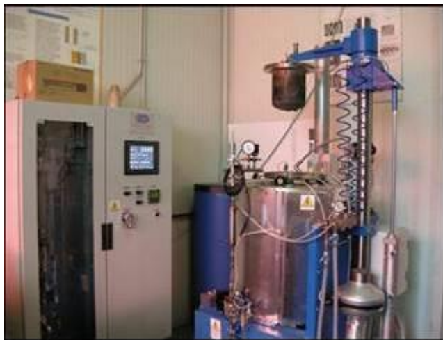
Figura II.5.1 - Impianto diffusion coating presso CSM (sotto) e dettaglio retort (sopra)
