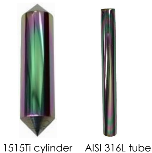
Figura 4. Campioni cilindrici, pieni e cavi, destinati a prove di corrosione.
