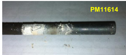
Figura 10: Aspetto del campione di 15-15Ti ricoperto con Ta dopo esposizione in piombo a 480°C a basso ossigeno ( 10^{-8} % in peso) e per 700 ore.
