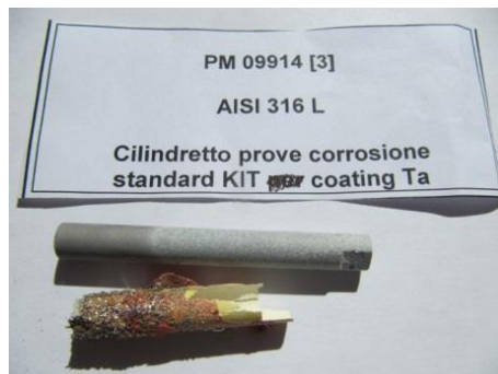
Figura 7: Aspetto di uno dei tre campioni di acciaio 316L ricoperti con Ta dopo esposizione in piombo a 480°C con alto ossigeno ( 10^{-4} % in peso) e per 1000 ore.
