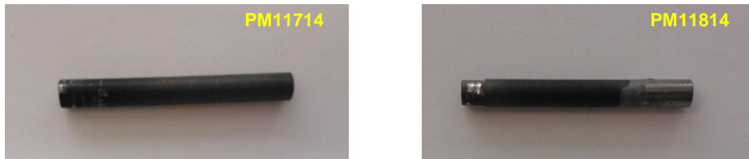
Figura 12: Aspetto dei campioni di 15-15Ti ricoperti con Ta dopo esposizione in piombo a 550°C con basso ossigeno ( 10^{-8} % in peso) e per 1000 ore.
