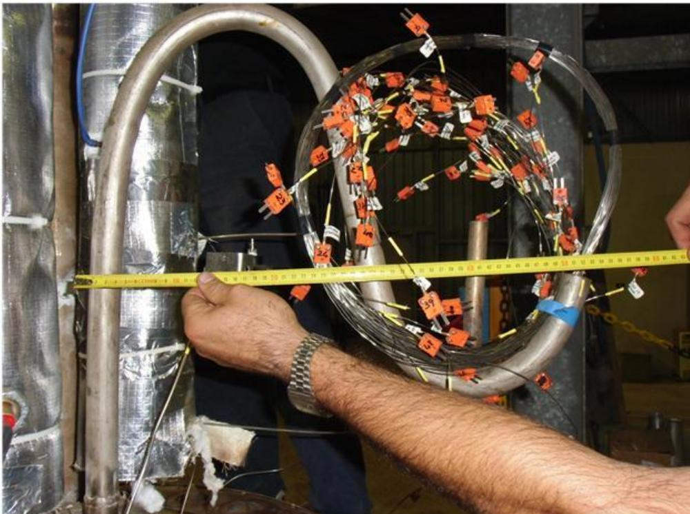
Fig. 5.7 – Tenuta TC con tubo collo d’oca (1 di 3).
