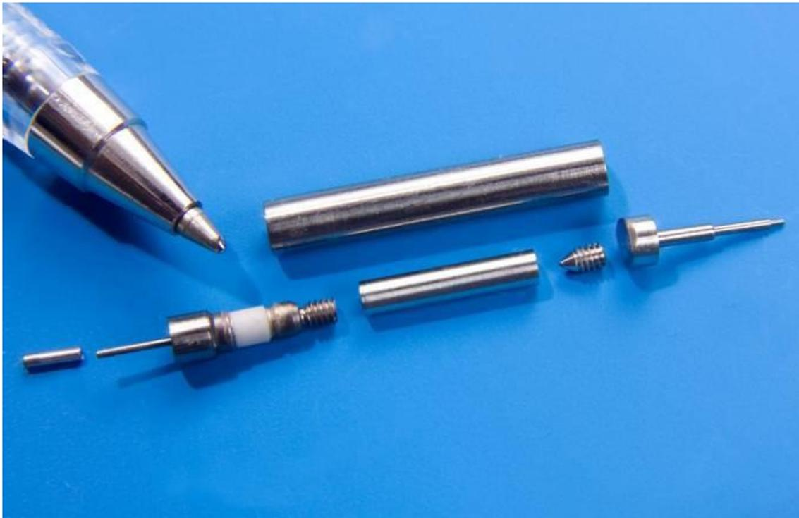
**Figura 3.9: Microcamera a fissione**
