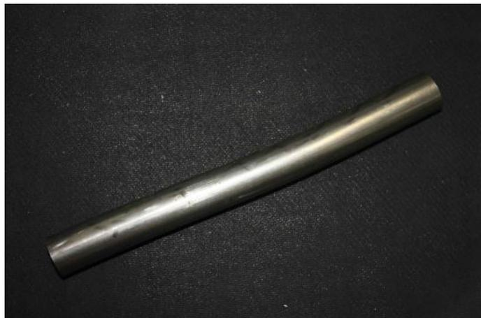
*Figura 48 – Immagine del campione in acciaio di 2cm di diametro deformato dopo i primi 6 cicli di carico.*
