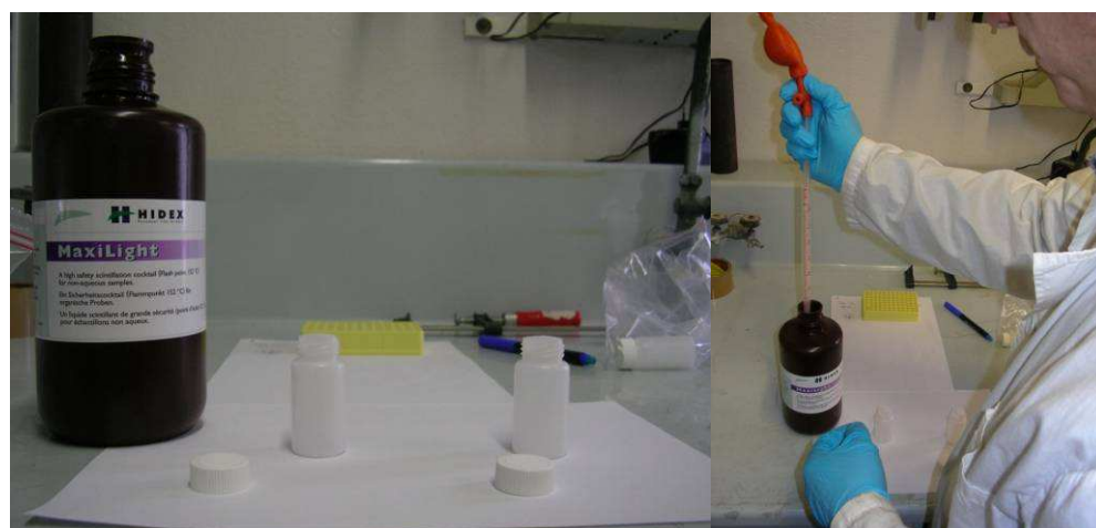
Figura 5: preparazione delle vials con 15 mL di Aqualight.
