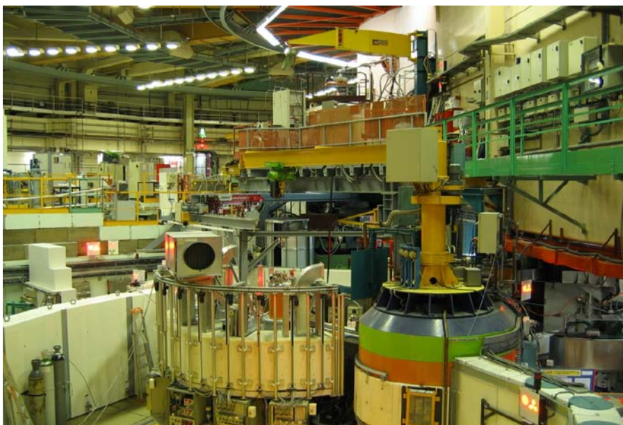
Fig. 3 – Foto del diffrattometro per diffrazione neutronica ad alta risoluzione D20 presso l'ILL-Grenoble
