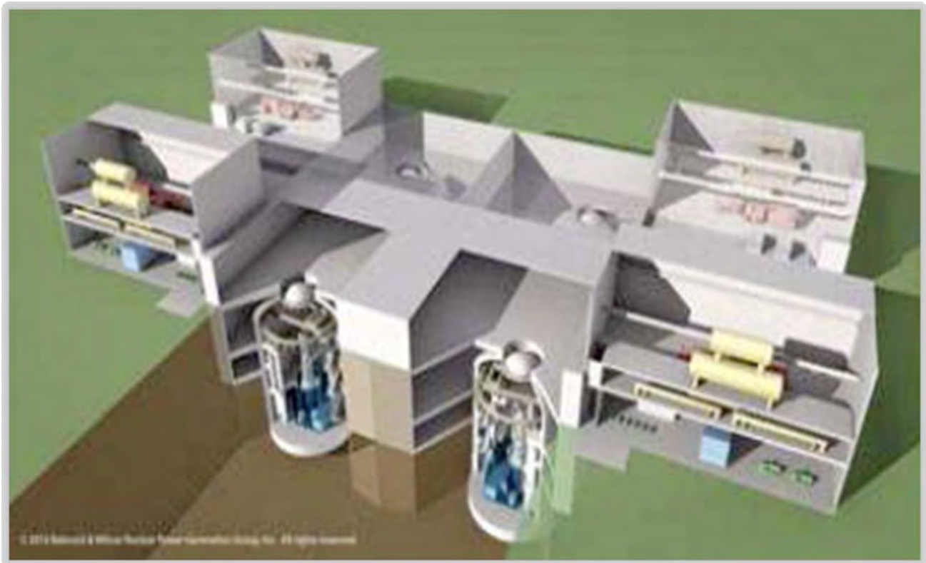
Fig.III.III: Esempio di 4 moduli mPower di B&W [fonte: B&W]
