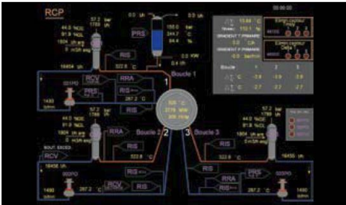
Fig. 5: Rappresentazione schematica di un PWR da 900 MWe.
