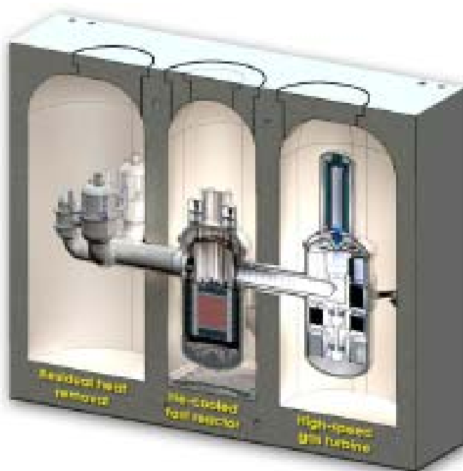
Figura 23: Schema concettuale del reattore EM2.
