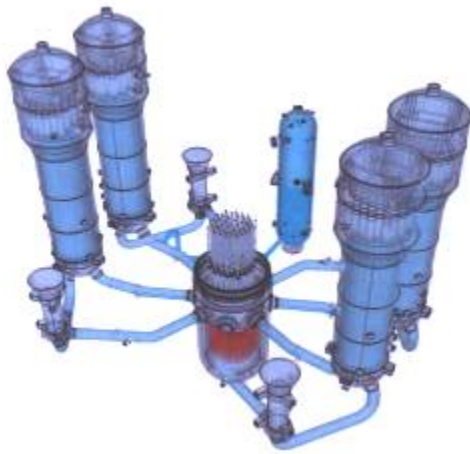
Figura 22. Il reattore PWR a quattro loop
