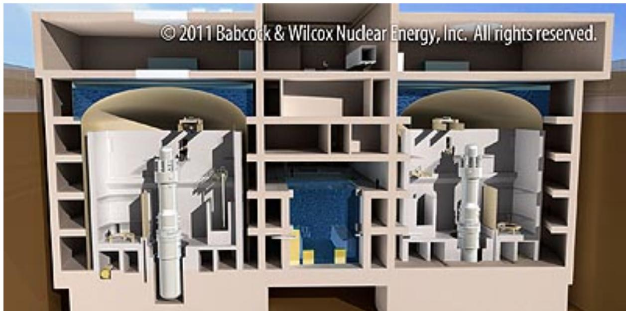
Figura 8. Spaccato di impianto mpower con due unità
