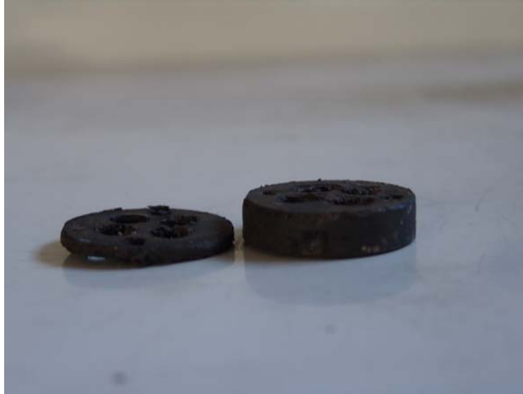
Figura 5 - Pacchi di tenuta in Karlez® 7090 delle barre Rotfil A destra il pacco inferiore, a sinistra il pacco superiore
