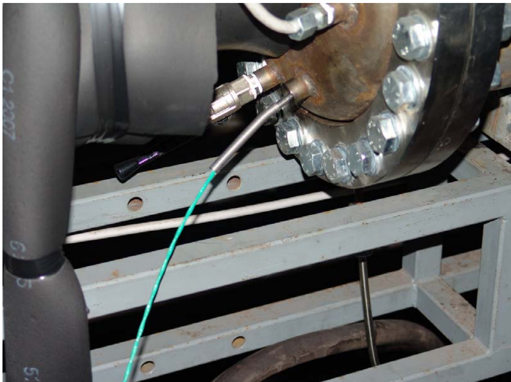
Figura 6: Termocoppia sul fondello inferiore del contenitore di sicurezza della sonda
