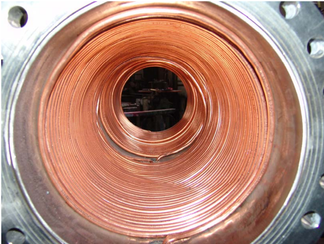
Figura 5: Solenoidi in rame per il raffreddamento della zona contenente i circuiti stampati
