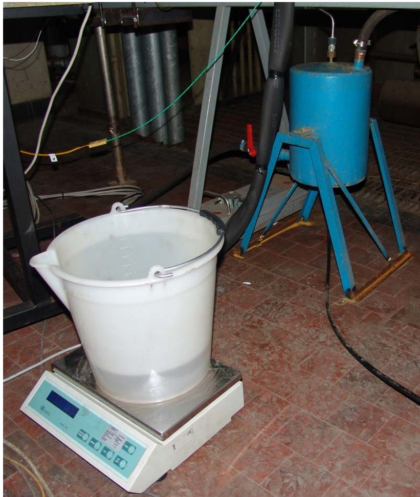
Figura 13: Condensatore e bilancia da laboratorio
