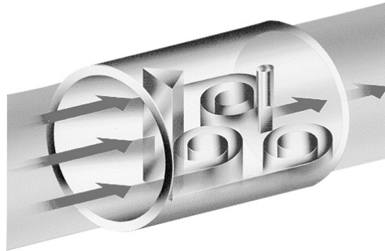
Figura 18: Principio di funzionamento del misuratore vortex
