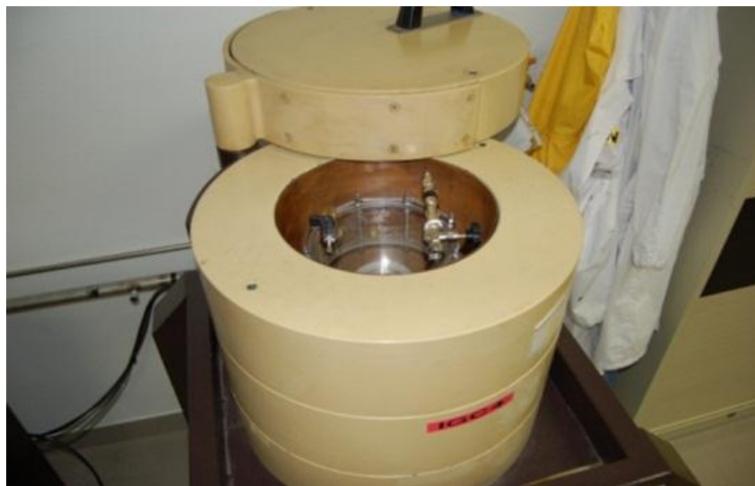
Figura 11: Rivelatore a basso fondo della ORTEC (HPGe N-type), inserito nel pozzo di schermaggio di piombo.
