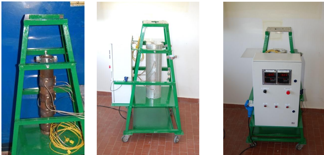
Figura 10: Riscaldatore per l'estrazione dei gas nobili dalla colonna dei carboni attivi.
