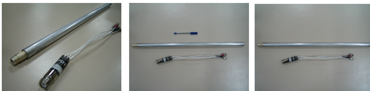
Figura 1 - Rivelatori Boron coated ed elettronica associata.
