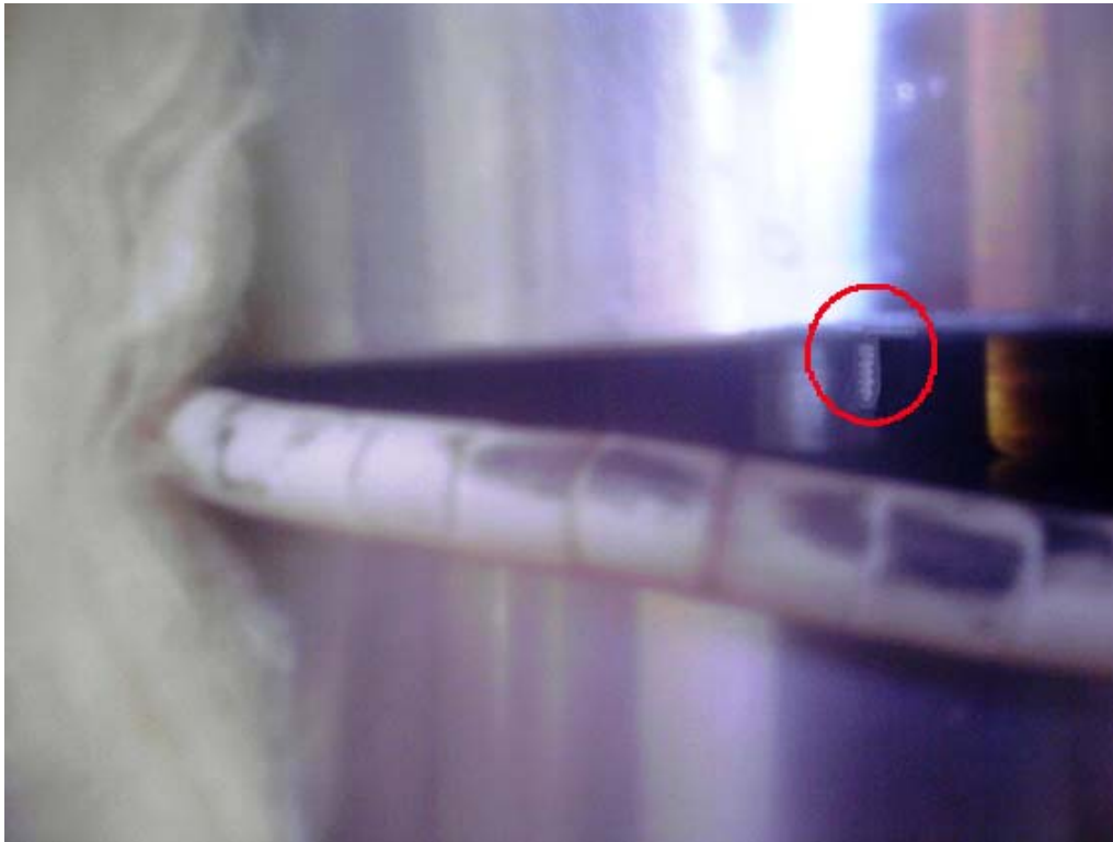
Fig. 4.5 - Goccia d’acqua indicante la non perfetta tenuta durante il secondo giorno di prove
