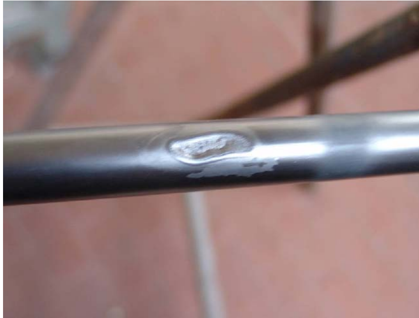
Fig.7. 1 – Dettaglio schiacciamento locale dell'elemento scaldante del pressurizzatore
