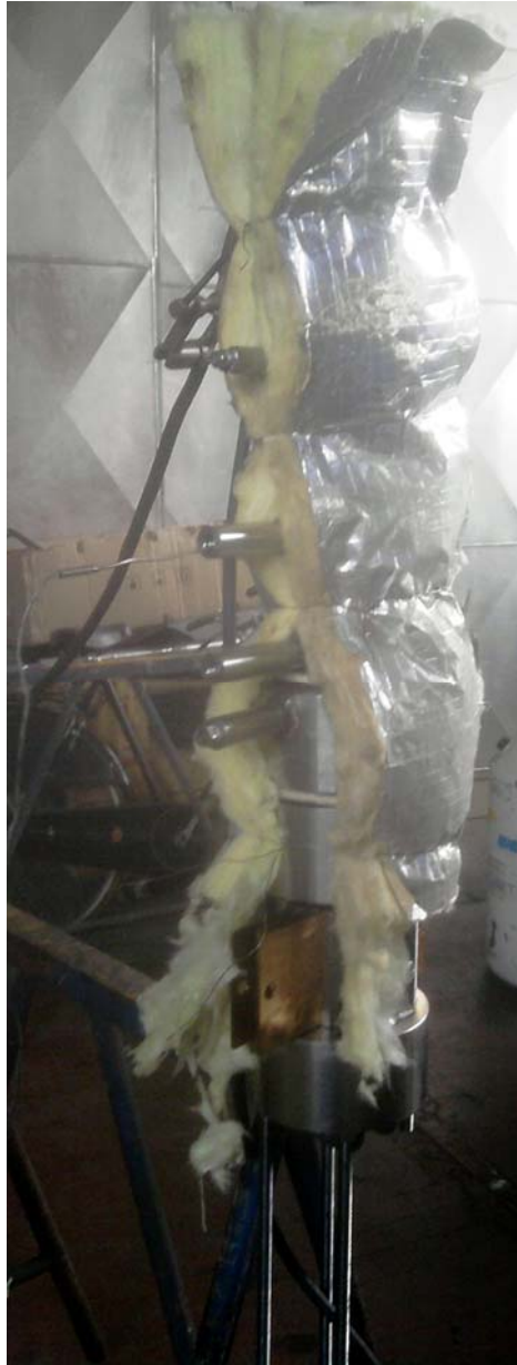
Fig. 4.4 - Coibentazione della tenuta
