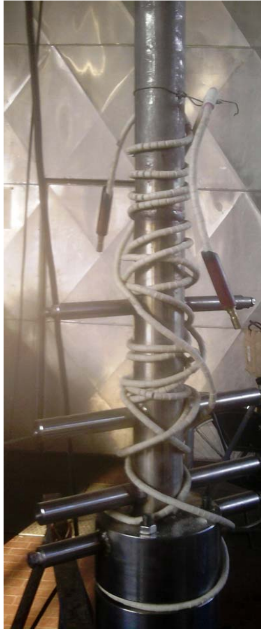
Fig. 4.3 - Riscaldamento elettrico esterno della tenuta
