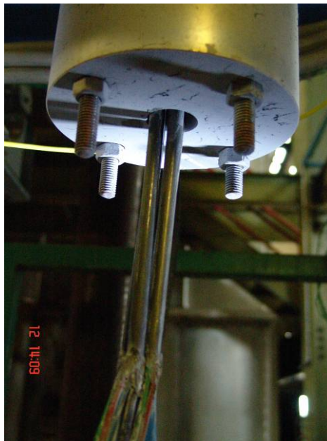
Fig.7. 2 – Terminazioni elettriche delle barre con guaine danneggiate
