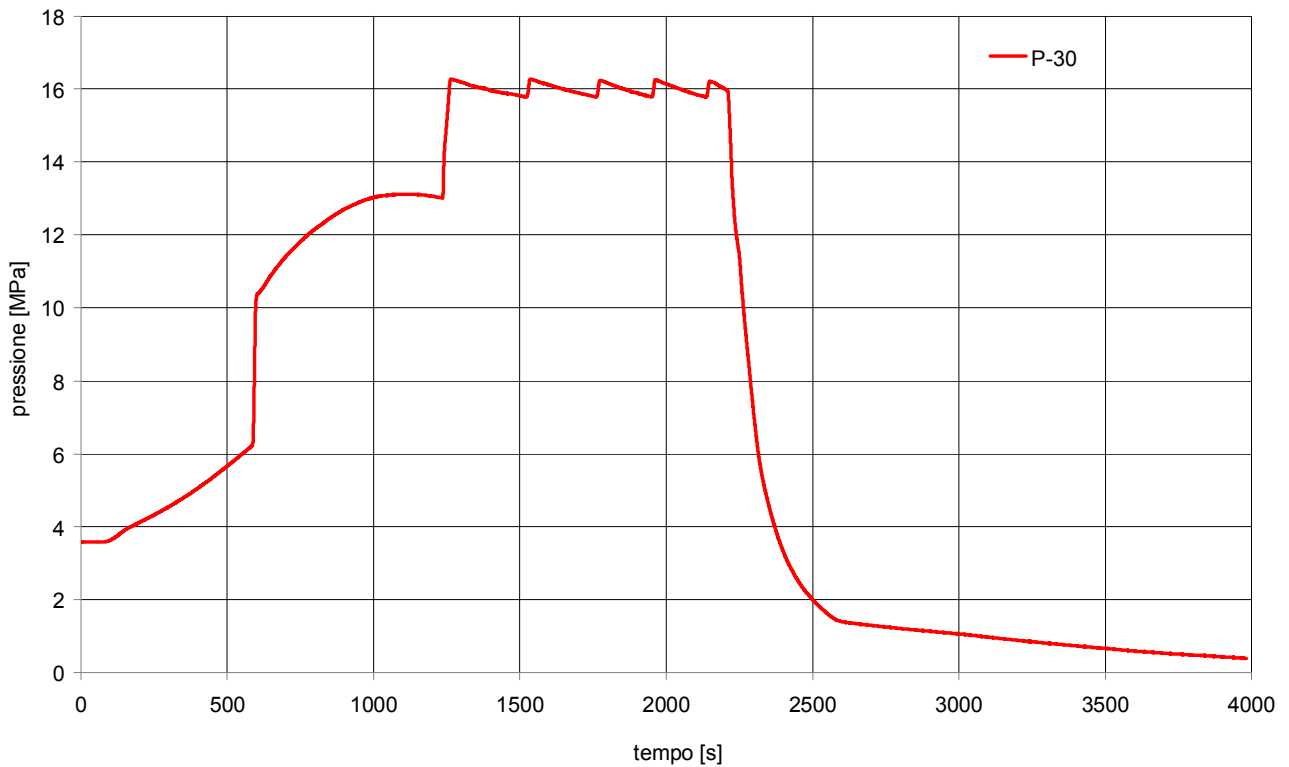
Fig. 8. 196 - Andamento della pressione del circuito prova barre per il Test n°31
