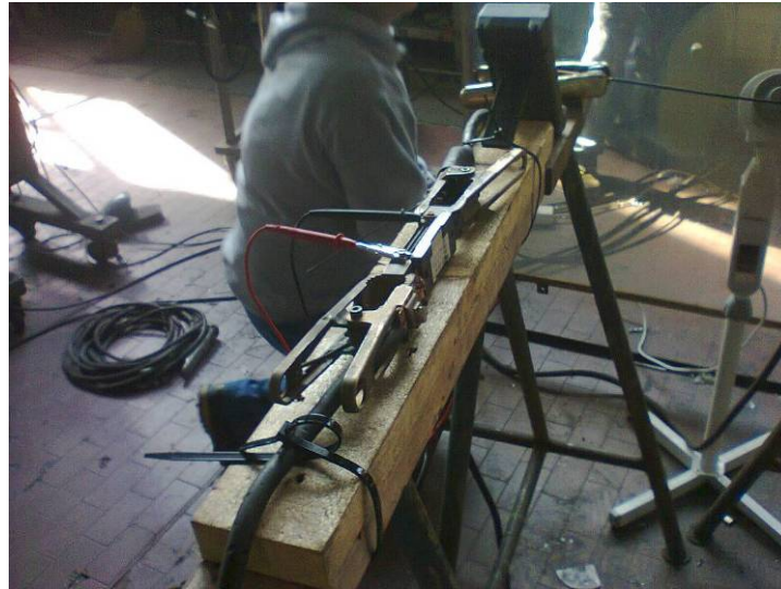
Fig.7. 4 –Allestimento per prove sulle guaine: collegamento morsetti
