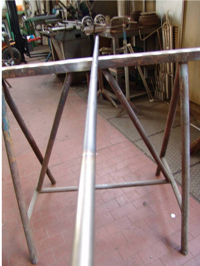
Fig. 5. 1 - Candela scaldante del pressurizzatore
