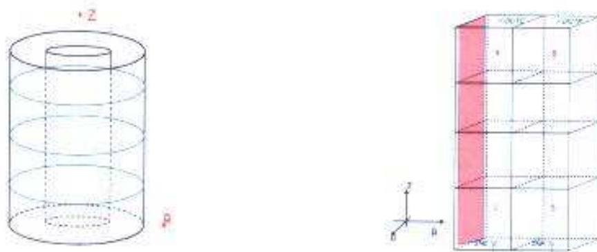
Fig. 5-21 Il modulo 3D del CATHARE: schematizzazione del nocciolo
