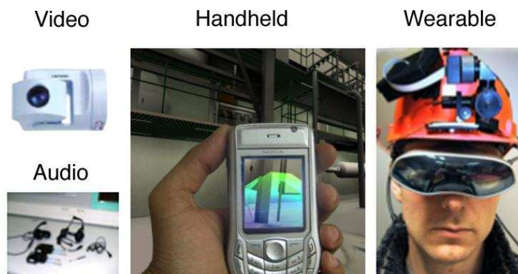
Fig. 5-7 Apparecchi digitali per migliorare l'operabilità degli operatori di centrale
