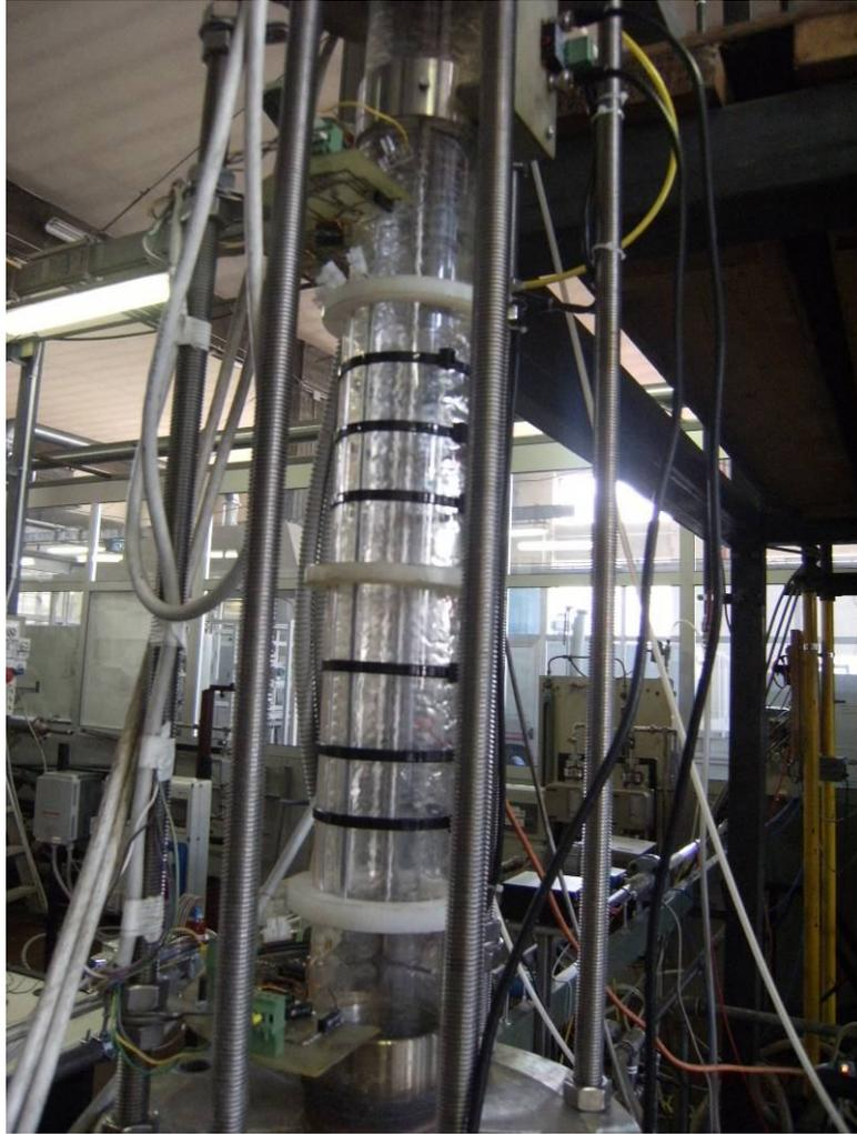
**Fig. 8 - Sonda capacitativa a freddo operante in flusso bifase**
