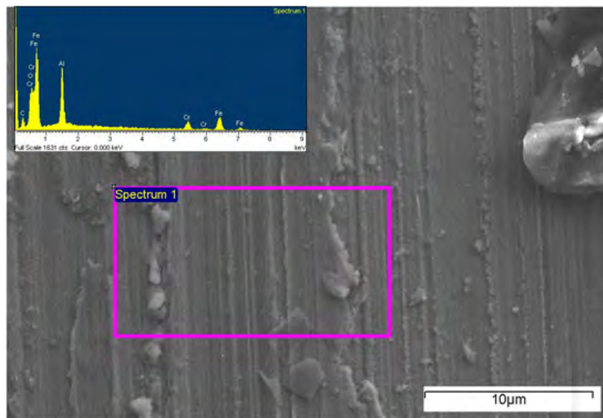
Figura 43. Micrografia SEM e spettro EDS della superficie della sorgente FeCrAl.
