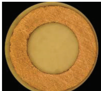
Fig. 40 – Particolare della finitura della guarnizione in rame realizzata per tornitura e lucidata (visione ingrandita al microscopio ottico)
