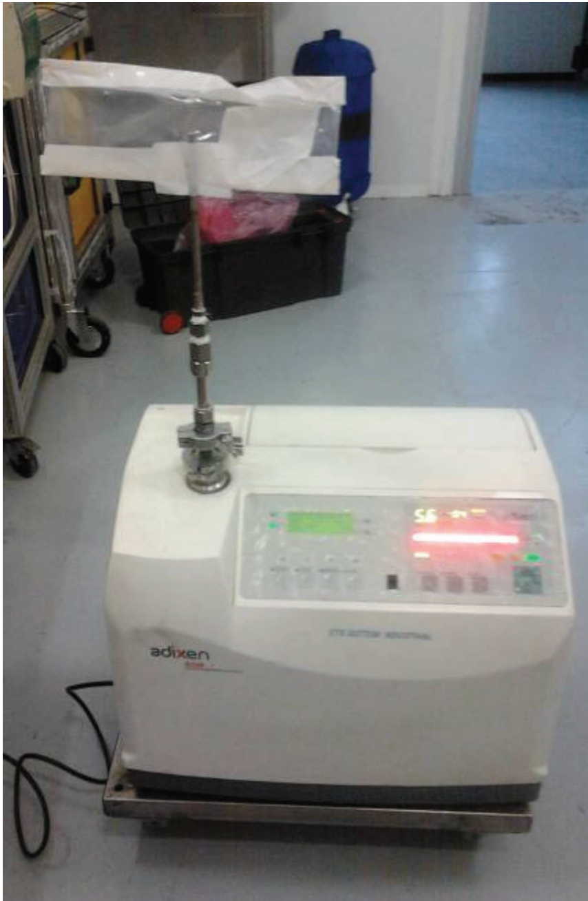
Fig. 28 – Strumento impiegato per la prova di tenuta in He (a sinistra) e “tool” specifico per l’accoppiamento del provino con lo strumento (a destra)
