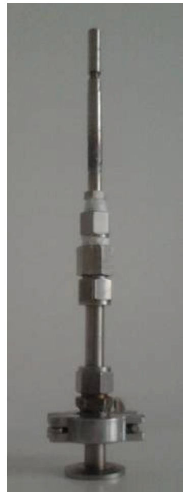
Fig. 28 – Strumento impiegato per la prova di tenuta in He (a sinistra) e “tool” specifico per l’accoppiamento del provino con lo strumento (a destra)
