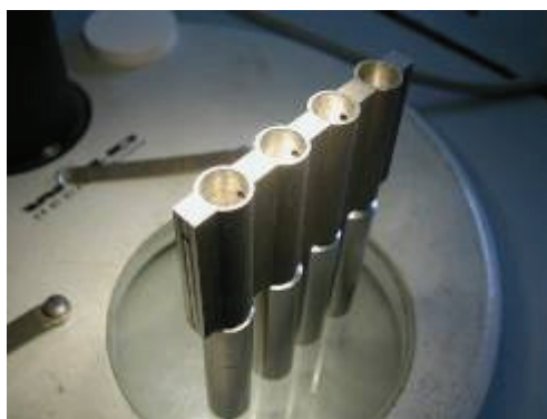
Fig. 26 – Visione del canale laterale che collega le 4 posizioni (a sinistra), accoppiamento barretta/griglia prima della saldatura interna: si nota che la parte superiore del provino barretta deve essere a filo del piano interno della griglia in cui viene effettuata la saldatura (a destra)
