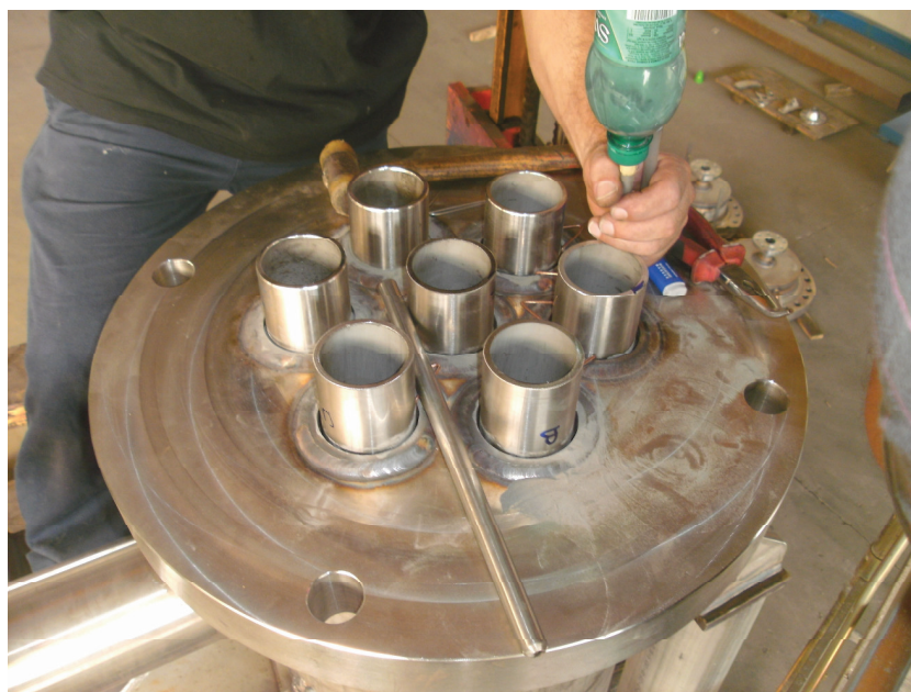
Figura 2 Fase del riempimento del gap con polvere di acciaio.
