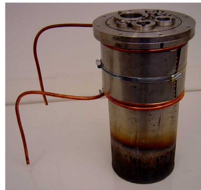
Serpentina di raffreddamento in rame
