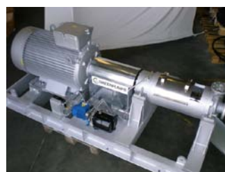
Pompa di circolazione centrifuga impianto HELENA e girante ricoperta in Tantalio
