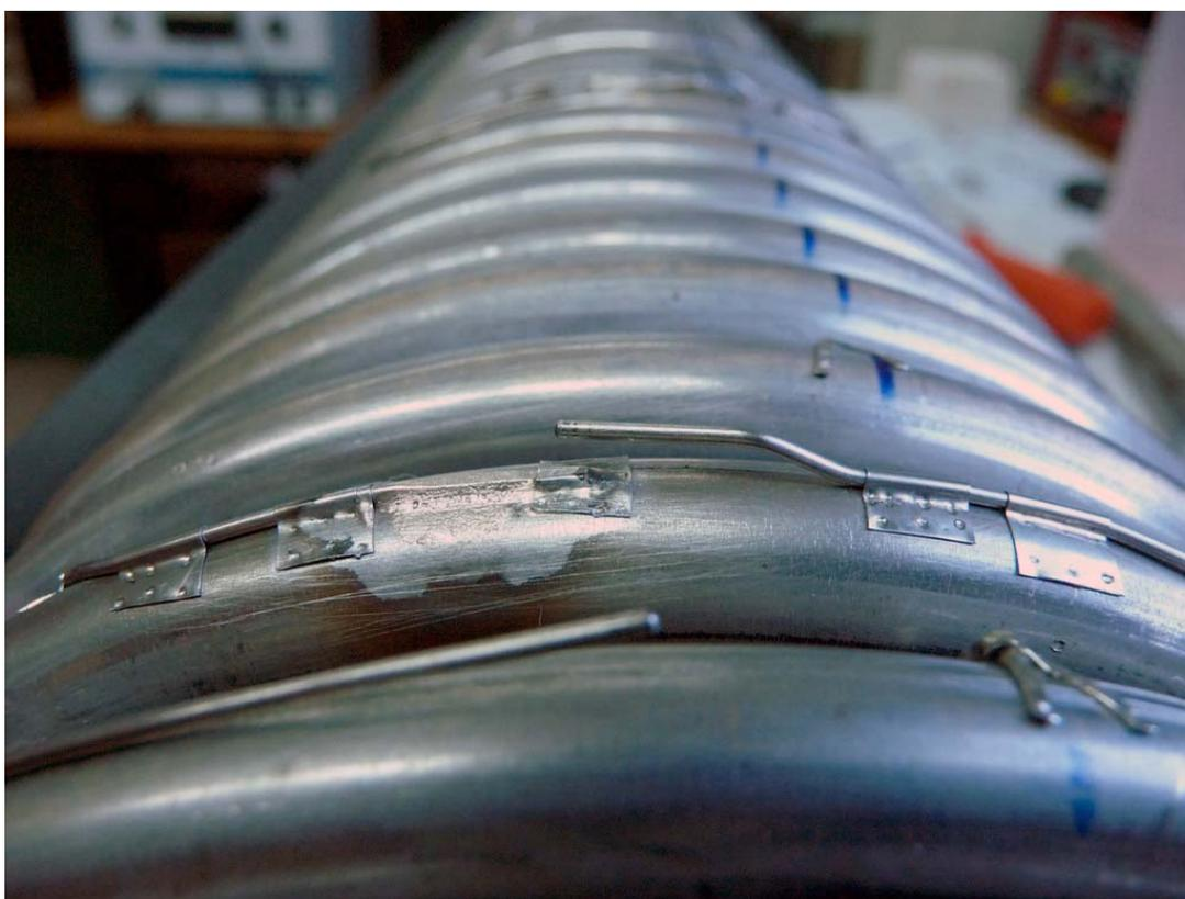
**Foto 3.2** – Dettaglio di un punto di misura completo sul tubo della Sezione di Prova
