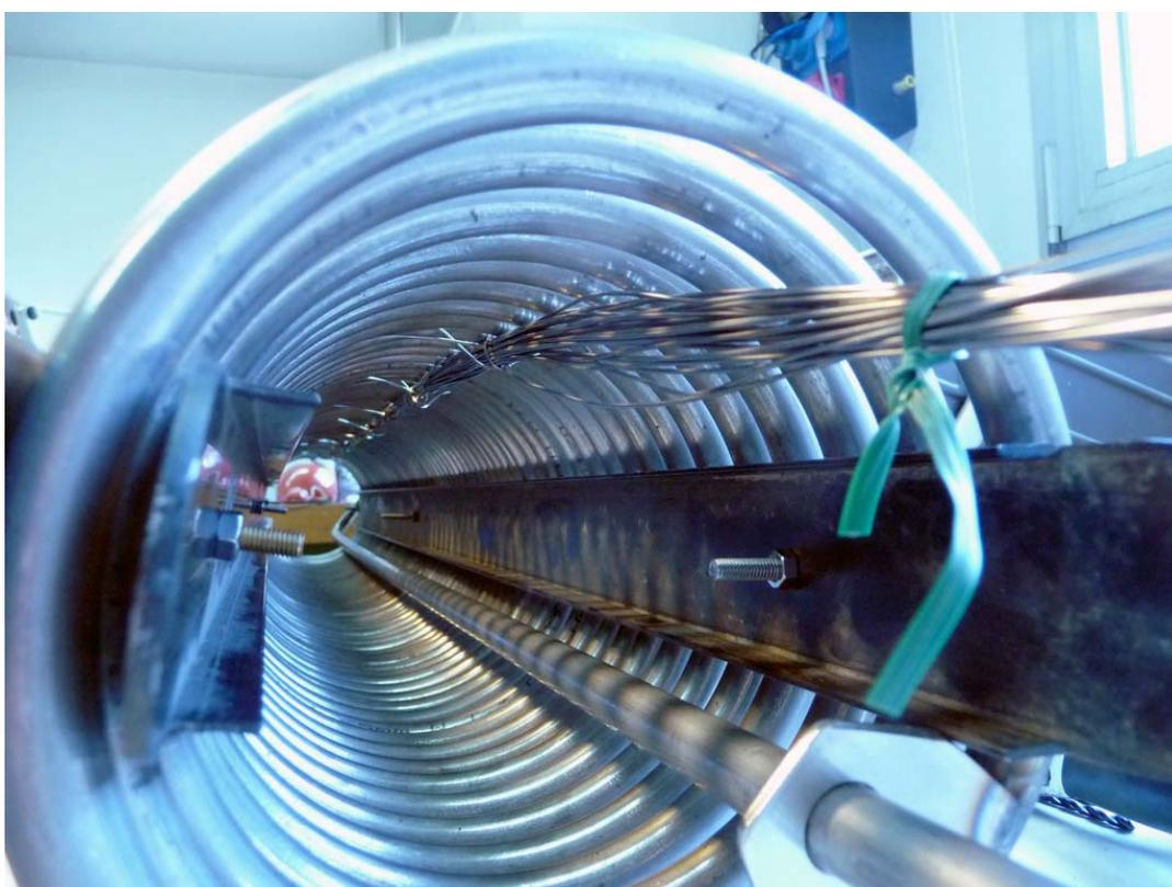
**Foto 3.4** – Particolare dell'uscita del mazzetto di TC
