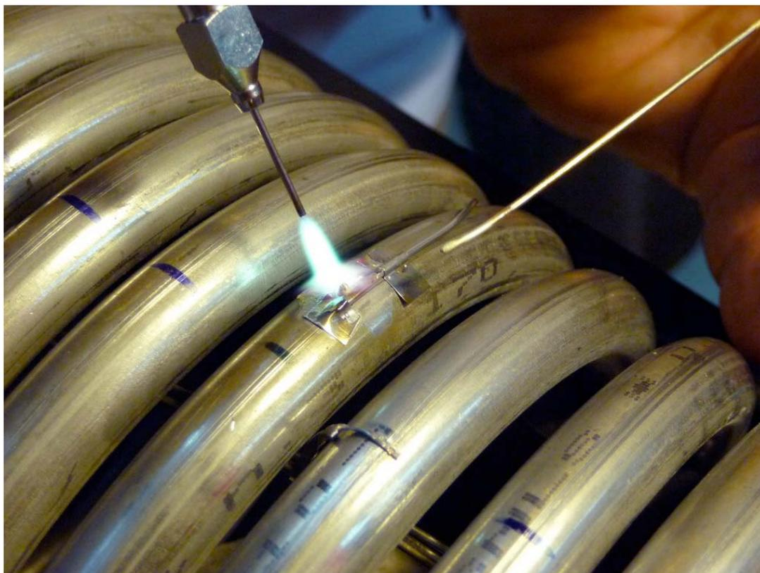
**Foto 3.1** – Particolare del fissaggio di una TC sul tubo della Sezione di prova
