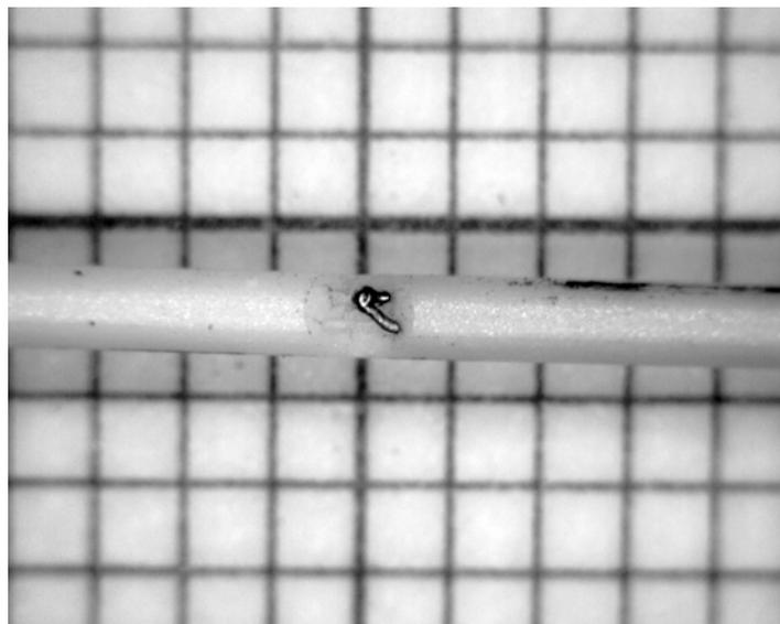
**Fig. 1.2** - Particolare di un sensore miniaturizzato: è distinguibile il punto di saldatura dei due fili di platino del riscaldatore all'interno della guaina. Si vede bene il diametro della guaina di 0,6 mm, in riferimento ai quadrati della carta millimetrata di lato 1 mm
