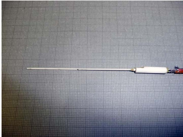
**Fig. 1.1** – Particolare dell'intera sonda ; si noti al centro la cava realizzata per raggiungere i fili di platino inseriti nel corpo della sonda stessa
