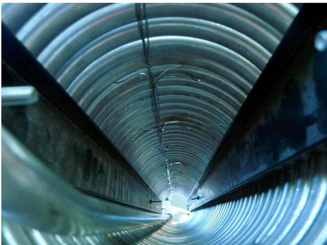
**Foto 3.3** – Particolare del passaggio delle TC ammazzettate all'interno della spirale
