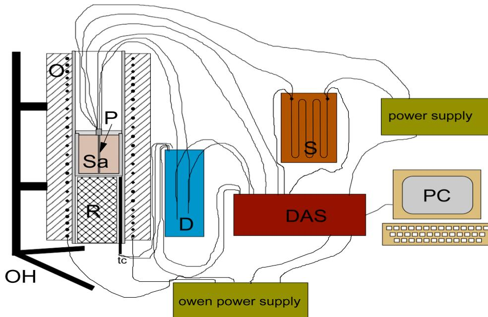
Fig. 2.2 – Schema per l'apparato in corso di allestimento per la misura della conducibilità termica di miscele di sali fusi. (R=refrattario, O=forno, P=sonda contenente il campione (Sa), DAS= scheda acquisizione dati, D=Dewar, S= shunt)
