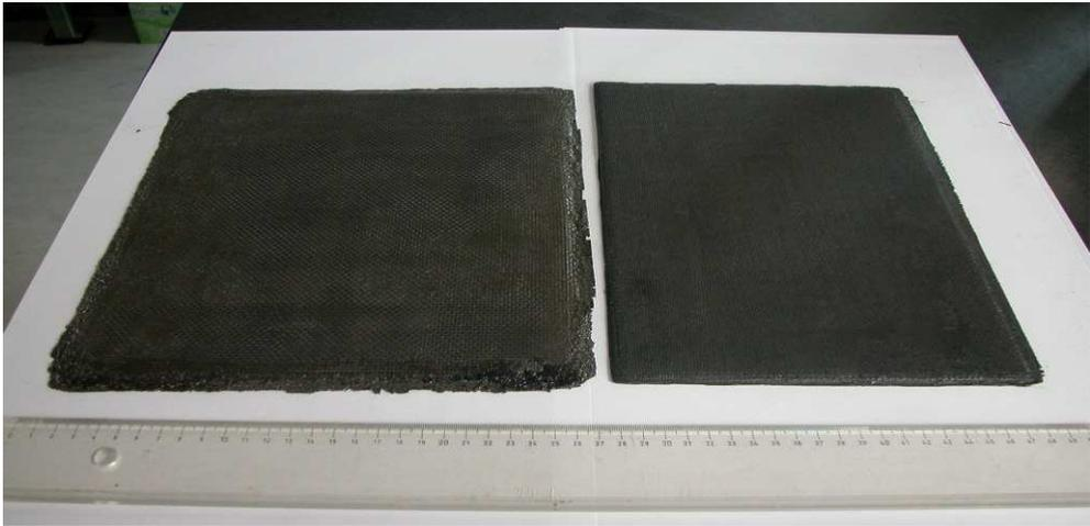
**Fig. 24 – Foto pannelli C/C e SiC ottenuti mediante CVI**
