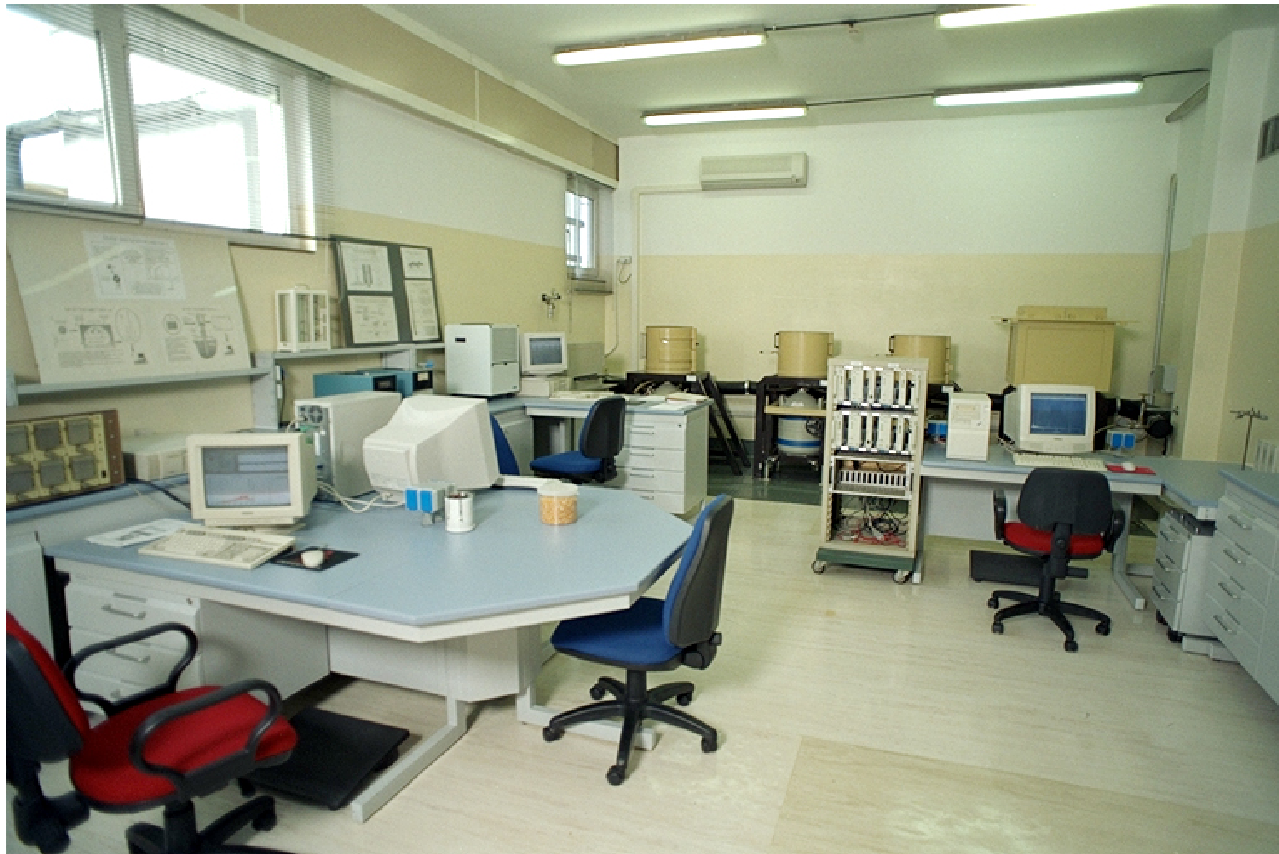
Fig.9 – Sala Conteggi con sullo sfondo catena di spettrometria gamma e pozzetti di conteggio
