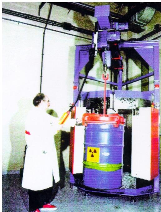
**Figura 1: Testa di misura presente presso l'Impianto Plutonio del C.R. Casaccia**
