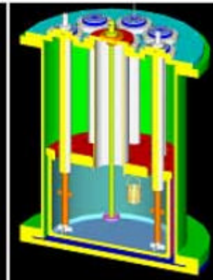
Vista in 3D dell'elettrorefinatore
