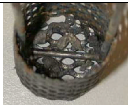
Interno del cestello anodico
