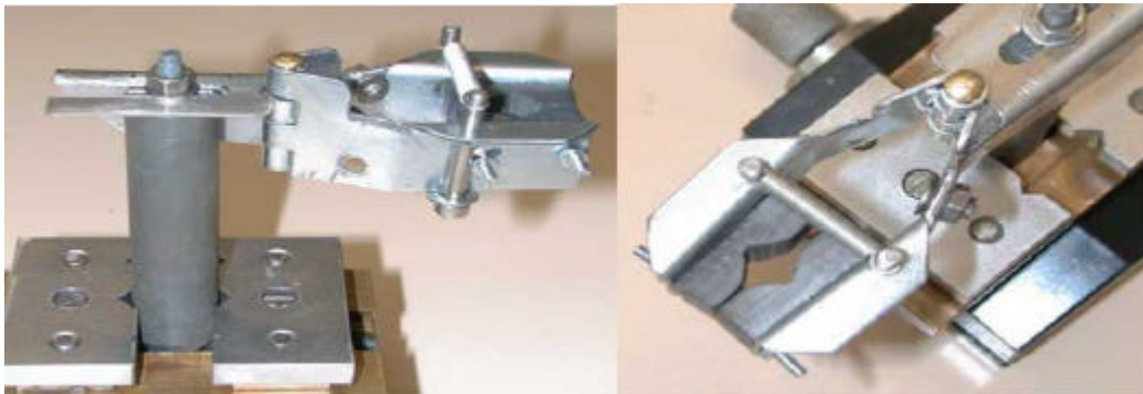
Pinze con contatto elettrico in grafite per catodo rotante
