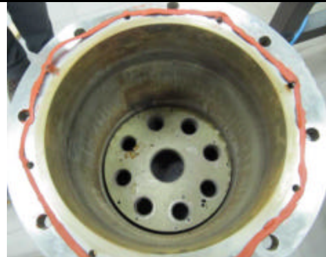
Interno vessel con il crogiolo inserito
