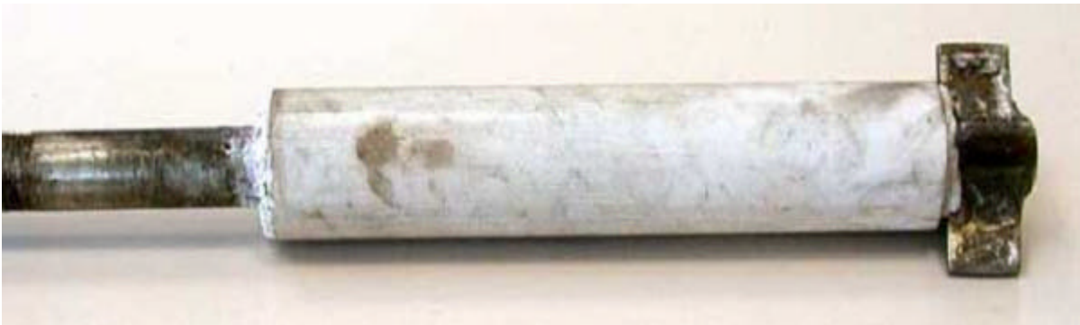
Figura 12 - Agitatore ad elica rivestito in allumina per l'isolamento elettrico dal sale
